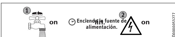
► Abra y cierre todas las válvulas de salida conectadas al menos cinco veces en total. Deje correr el agua durante al menos tres minutos, hasta que se haya purgado todo el aire de la tubería y el calentador de agua.
